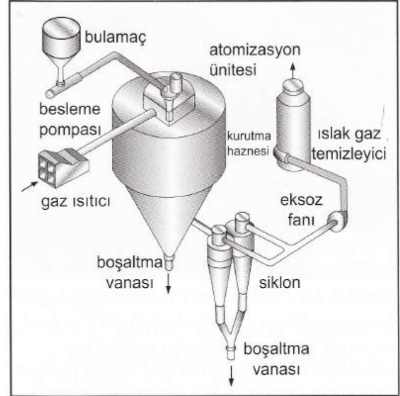
Şekil 5.33. Püskürtmeli kurutma sisteminin bileşenleri; ısıtılmış gaz, toz-bağlayıcı bulamacının atomize edilmesinde kullanılmaktadır. Bulamaç ısıtma haznesinde kuruma esnasında küresel topaklanmalar oluşturur.
