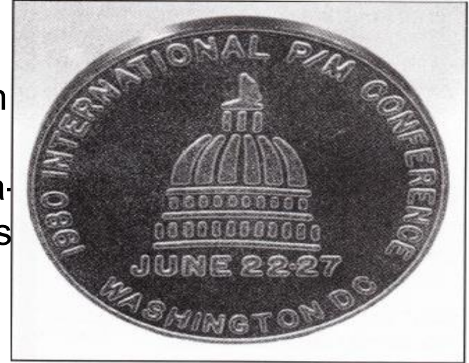
Şekil 12.3. Yüzey damgalamasından dolayı oluşan bölgesel deformasyonun görünümü, iş parçası olarak tanımlanan sinterlenmiş taslakta oluşmuş baskı; preslenmiş ve sinterlenmiş tozdan oluşan metal para örneği.
