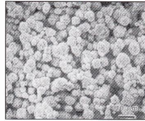
Şekil 3.12. Karbonil bozunması ile oluşturulmuş nikel tozunun taramalı elektron mikroskop görüntüsü (Fotoğraf: Tai Shing Wei).
