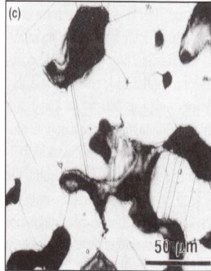
Şekil 8.33. Bakır-kalay karışım tozlarında (90:10 bronz) çeşitli sinterlenme aşamalarında oluşan mikroyapılar; (a) 600 °C'ye kadar ısıtılmış (kalay ergidikten sonra), (b) 810 °C'ye kadar ısıtılmış ve (c) 850 °C'de 5 dak sinterlenen parça.
