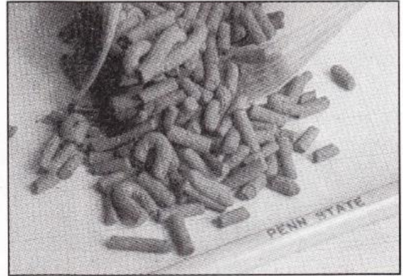
Şekil 5.31. Kalıplama makinesine yüklenmek üzere hazır toz-bağlayıcı besleme stoğu peletlerinin resmi.
