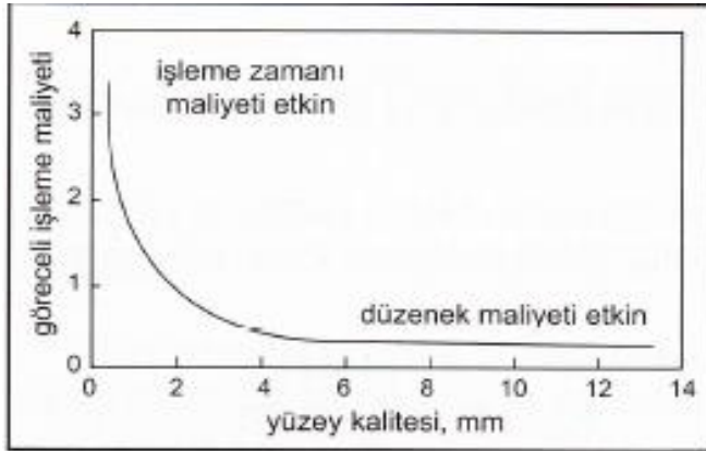
Şekil 12.5. Göreceli talaşlı imalat maliyetinin son yüzey kalitesine göre değişimi. Son yüzey kalitesi arttıkça talaşlı imalat maliyeti hızla artmaktadır. Böylece etkin maliyetli sinterlenmiş malzemeler için aralık oluşmaktadır.
