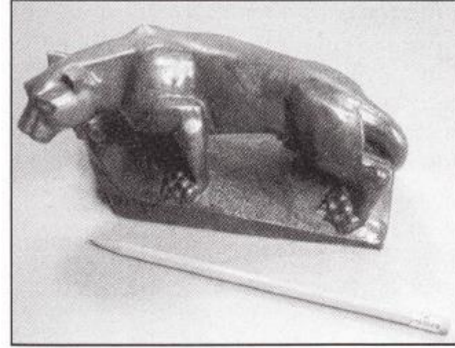
Şekil 6.23. Şekilde görülen bronz heykel sulu çamur döküm yöntemiyle toz-polimer karışımını kauçuk bir kalıp boşluğuna döküp basınç uygulamadan üretilmiştir.
