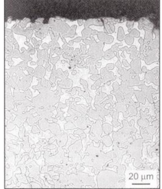
Şekil 12.23. Bakır infiltrasyonu esnasında hızlı soğutulmuş bir numunenin metalografik kesit görünümü (Jean Stewart'ın izni ile).
