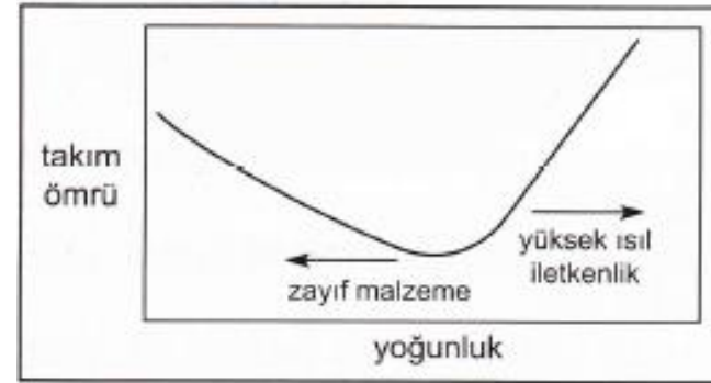
Şekil 12.6. Kesici takım ömrünün parça yoğunluğu ile değişimi. Yüksek yoğunluklu parçalarda takım ömrü iyileşir. Bunun sebebi, gözenek azlığından dolayı, takım yorulması ve ısınmasının en aza inmesindedir. Düşük yoğunluklu parça zayıftır ve yorulma ile kesici takım ısınması sorunu olmasına rağmen, düşük parça dayanımından dolayı takım ömründe iyileşme görülür.
